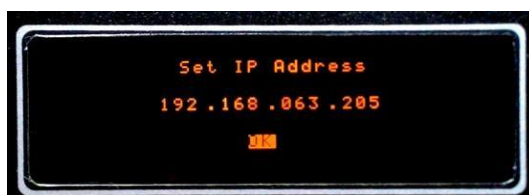
Рисунок 10 — Настройка IP-адреса. Выбор строки «ОК»
