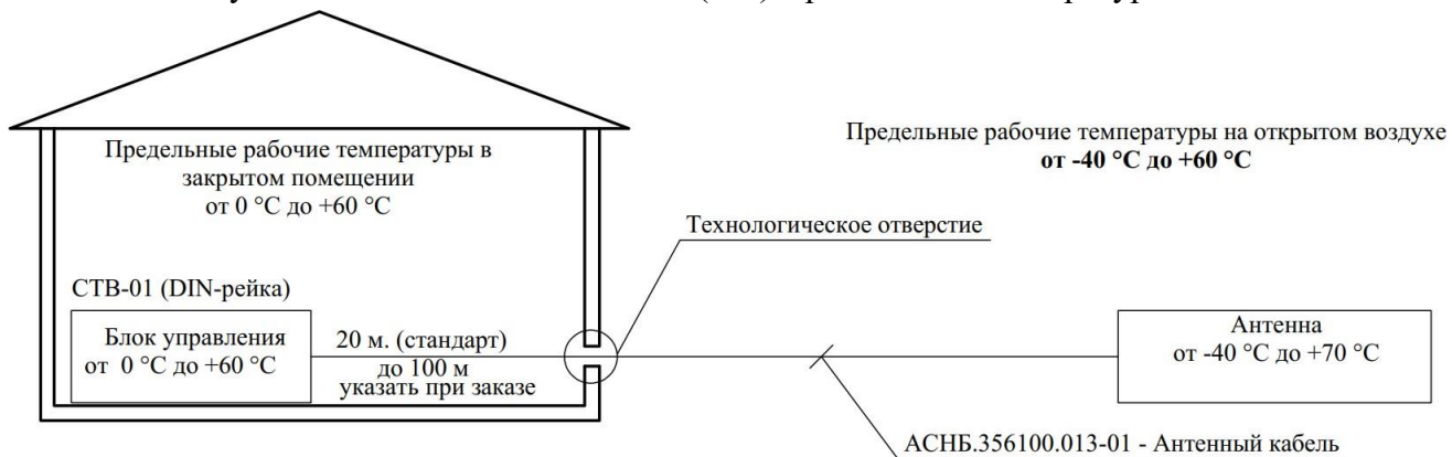
Рисунок 1.1 Подключение СТВ-01(19") в различных температурных диапазонах.
