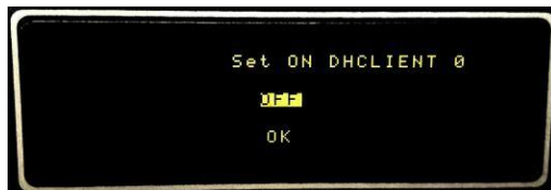
Рисунок 14— Настройка встроенного DHCP клиента
