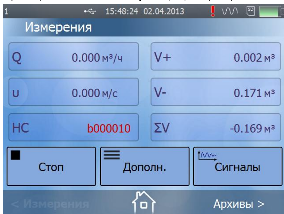
Рис.16. Отображение кода НС в меню «Измерения»
