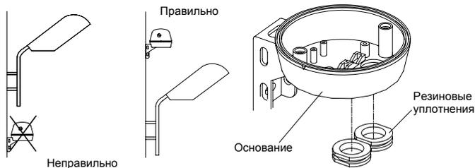
Вставьте провода в отверстия и произведите электрические соединения, как показано на рисунке
