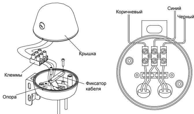
Закрепите провода с помощью фиксатора. Закройте устройство, совместив два маркера на крышке и основании, заверните крепежные винты.
