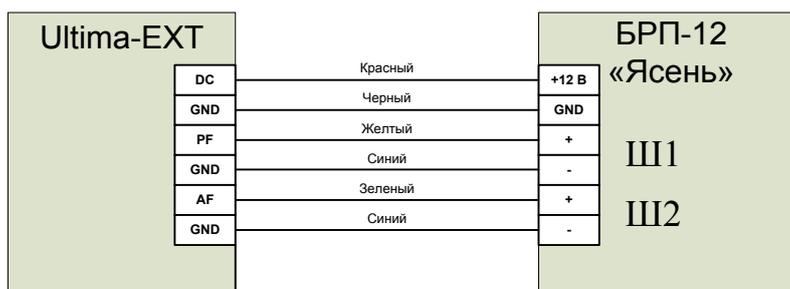
Рис. 9а. Схема подключения модуля к источнику питания
