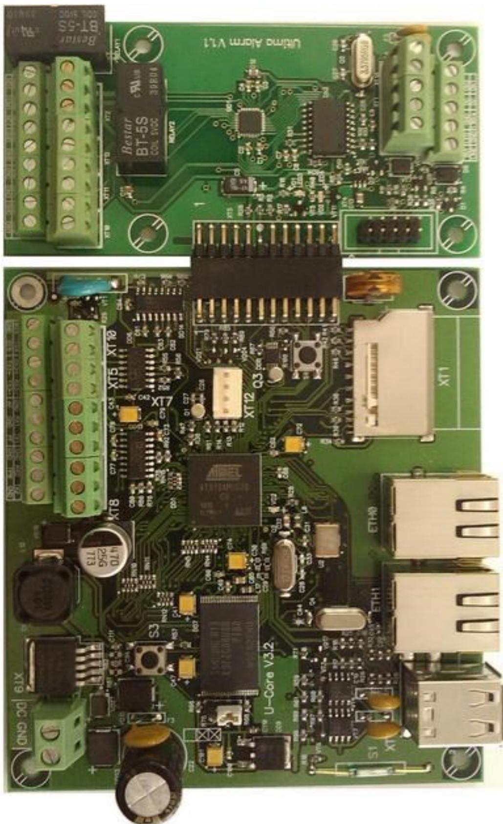
Рис. 16. Внешний вид модуля с платой ввода-вывода MA
