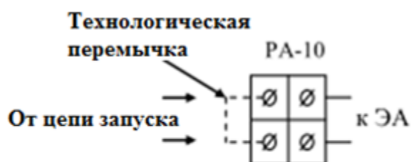
Рис.2 - Схема подключения ТРВ-Гарант вар. 1 с ППК общего пользования
