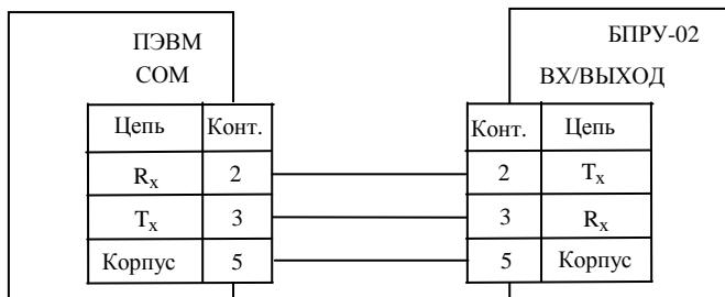
Рисунок 3.2 – Схема подключения изделия к ПЭВМ
