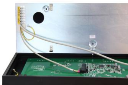
Съемная задняя крышка с разъемами
