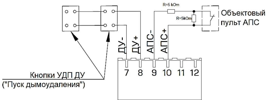
Рис. 5. Схема подключения пульта АПС и кнопок дымоудаления.
